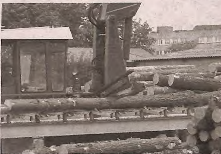
Cięcie dłużyc maszyną firmy Zembrod
